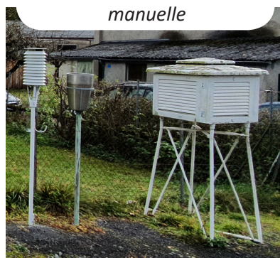
Les éléments de mesure de la station météorologique manuelle
